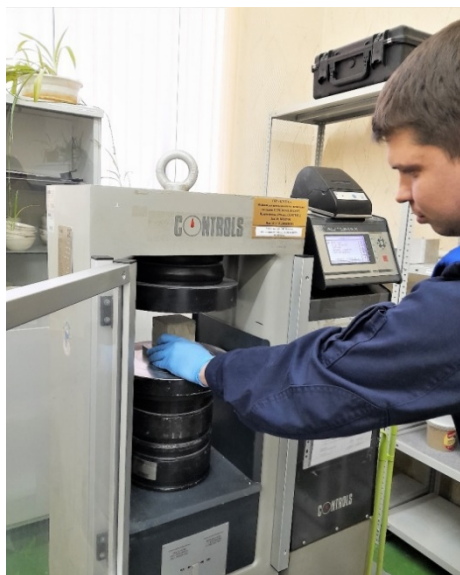
Рис. 2. Испытание бетонных образцов-кубов на прочность при сжатии
