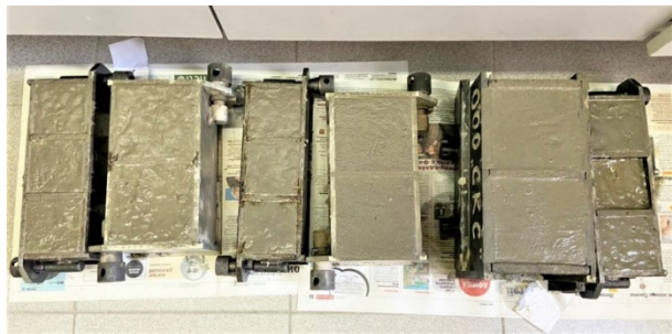
Рис. 1. Образцы-кубы из бетонной смеси в металлических формах
